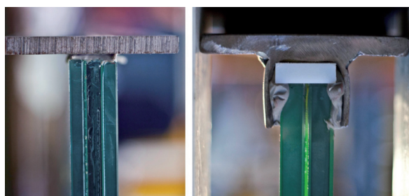
Obr. 1, Příčný řez nosníkem a – přímý spoj, b – spoj s profilem U
